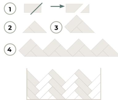
Para lograr el efecto espiga: (1) Cortar la pieza inicial con un ángulo de 45°. (2) Colocar ambas piezas de forma que las caras cortadas queden mirando hacia el suelo. (3) Este proceso se debe repetir hasta completar la primera fila. (4) Las siguientes filas de baldosas se colocan de forma que las caras largas de las piezas descansen sobre las caras cortas de las piezas de la fila anterior.
