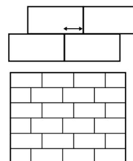
Para lograr el efecto traslapado, te recomendamos que el entrecruzamiento de las piezas se realice con un desfase del 25% del largo de la pieza instalada en la fila anterior.
