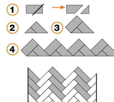
Para lograr el efecto espiga: (1) Cortar la pieza inicial con un ángulo de 45°. (2) Colocar ambas piezas de forma que las caras cortadas queden mirando hacia el suelo. (3) Este proceso se debe repetir hasta completar la primera fila. (4) Las siguientes filas de baldosas se colocan de forma que las caras largas de las piezas descansen sobre las caras cortas de las piezas de la fila anterior.
